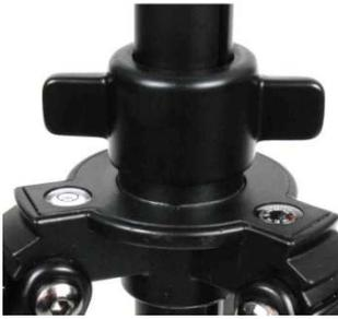
4. **Mittelsäule drehen:** Lösen Sie die Mittelsäulendrehklemme und den Teller mit dem Haken. Ziehen Sie die Mittelsäule komplett heraus. Dann setzen Sie die Mittelsäule umgekehrt von unten wieder in die Führung. Nun befestigen Sie den Teller mit Haken und ziehen die Mittelsäulendrehklemme fest.
