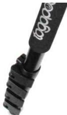
2. **Zur gewünschten Einstellung des Beinanschlagwinkels:** Durch Ziehen des togopod Buttons entriegeln Sie den Stativ - Beinanschlag. Sie können so zwischen drei Stativ Beinanschlägen wählen. Jedes Bein ist unabhängig justierbar. Durch Drücken des togopod Buttons wird das schwenkbare Stativbein verriegelt. Achten Sie immer darauf, dass bei Nutzung des FotoStativs mit aufmontierter Kamera die Beinanschläge verriegelt sind.
